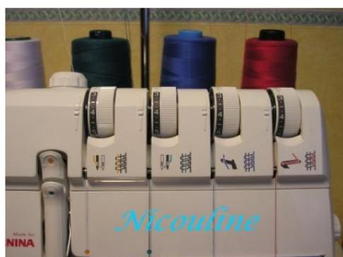
Des fils différents peuvent être utilisés pour les aiguilles et les **boucleurs**. Chaque fil passe dans un **support de guide fil**, puis dans un **tenseur** de fil. Quatre guides identifiés par un code de couleurs pour faciliter l'enfilage.
