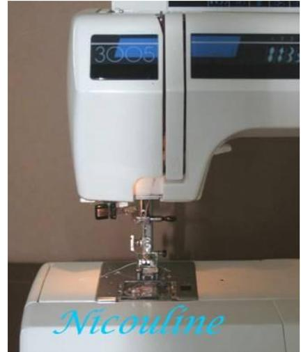
La **plaque à aiguille** comporte des lignes graduées qui serviront à guider l'ouvrage. Au-dessous de cette plaque, des **griffes** (parfois escamotables), animées d'un mouvement elliptique servent à l'entraînement du tissu.
