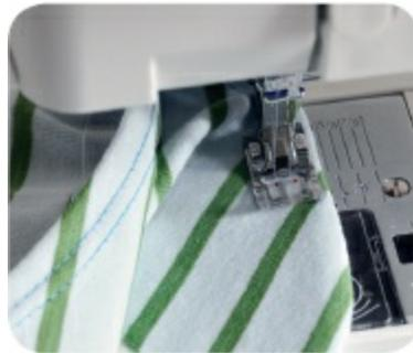
Surpiqûre de l'encolure au moyen d'une aiguille double stretch.
