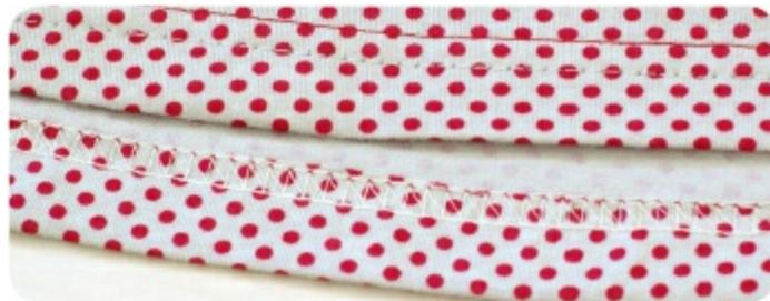
Ourlet sur jersey réalisé avec un point de recouvrement : au-dessus l'endroit du travail, en dessous l'envers avec le surfilage réalisé par la recouvreuse.
